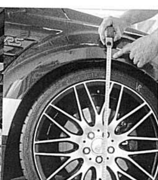
Po každé montáži se měřilo snížení vozku, jestli odpovídá údajům výrol
