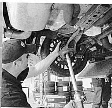
Profesionálním servismanům trvá výměna pružin a tlumičů slabou půlhodinu
